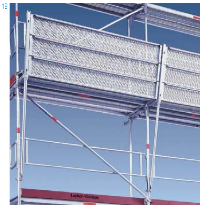
19 De puinvangconsole's kunnen worden dichtgelegd met zowel stalen- als robuustvlonders. De puinvangconsole's zorgen ervoor dat publiek zonder gevaar langs de steiger kan lopen.
