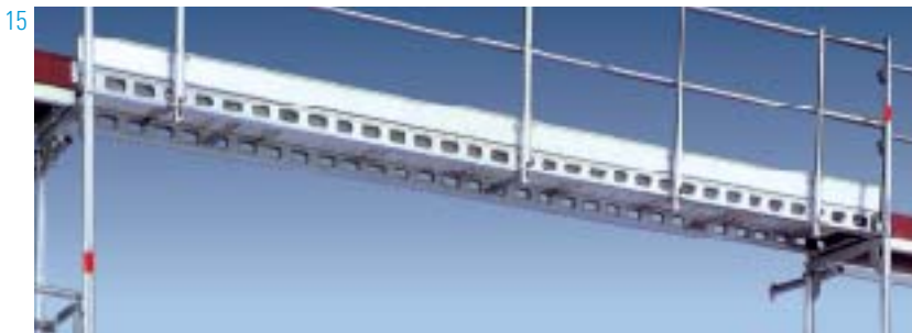
15 Grote overbruggingen kunnen eenvoudig met 0.60m brede werkbruggen worden gerealiseerd. De toelaatbare belasting op deze werkbruggen varieert van 1.5kN/m 2 tot 2kN/m 2 , afhankelijk van de lengte (3.18m tot 10.00m).
