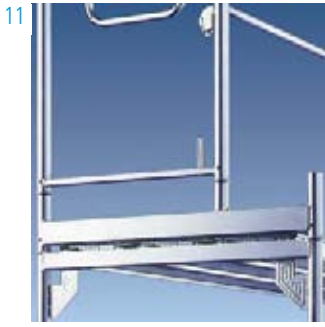
11 Met een verloopbalk kan men de 1.09m brede Blitz-steiger versmald worden naar 0.73m.
