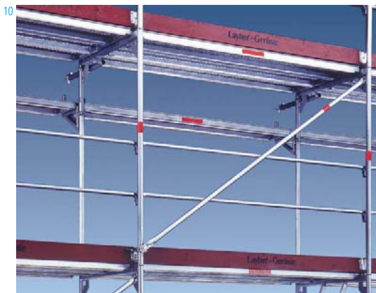
10 Voor metselwerk op een 1.09m brede Blitz-steiger kan eenvoudig een console van 0.36m breed op elke gewenste hoogte worden toegepast. Hierdoor ontstaat er een werksituatie die altijd optimaal is.
