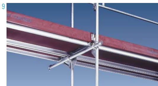
7, 8, 9 De Blitz-steiger kan aan beiden zijden m.b.v. consoles. (0.36m en 0.73m breed) eenvoudig verbreed worden. Deze consoles kunnen op elke hoogte ingehangen worden. Hierdoor ontstaat een optimale werksituatie. consoles van 0.73m moeten worden geschoord m.b.v. standaard diagonalen.
