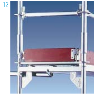
11 Met een verloopbalk kan men de 1.09m brede Blitz-steiger versmald worden naar 0.73m.
