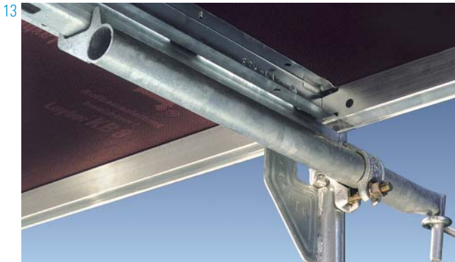
13 Het Layher programma bevat een tweetal verankeringen welke zich uitstekend lenen voor de Blitz-steiger. Één type wordt bevestigd met een kruiskoppeling in de schetsplaat en één welke in beide schetsplaten van het stelraam wordt bevestigd. Beide zijn veilige manieren om de Blitz-steiger te verankeren.
