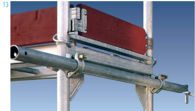
13 Het Layher programma bevat een tweetal verankeringen welke zich uitstekend lenen voor de Blitz-steiger. Één type wordt bevestigd met een kruiskoppeling in de schetsplaat en één welke in beide schetsplaten van het stelraam wordt bevestigd. Beide zijn veilige manieren om de Blitz-steiger te verankeren.
