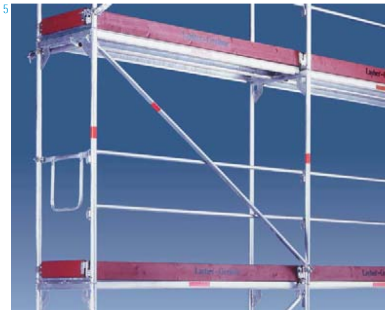
5 Met een hamerslag op de spie, worden de enkele of dubbele leuningen gefixeerd. De kantplanken en de dubbele kopleuning maken de bescherming van de werkvloer compleet.
